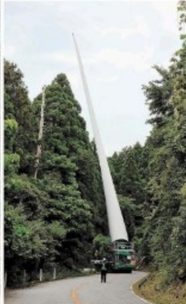
二枚田幹線林道を進むブレードを載せた台車。手前は歩きながら操縦する運転手＝7月4日、福井市和町
