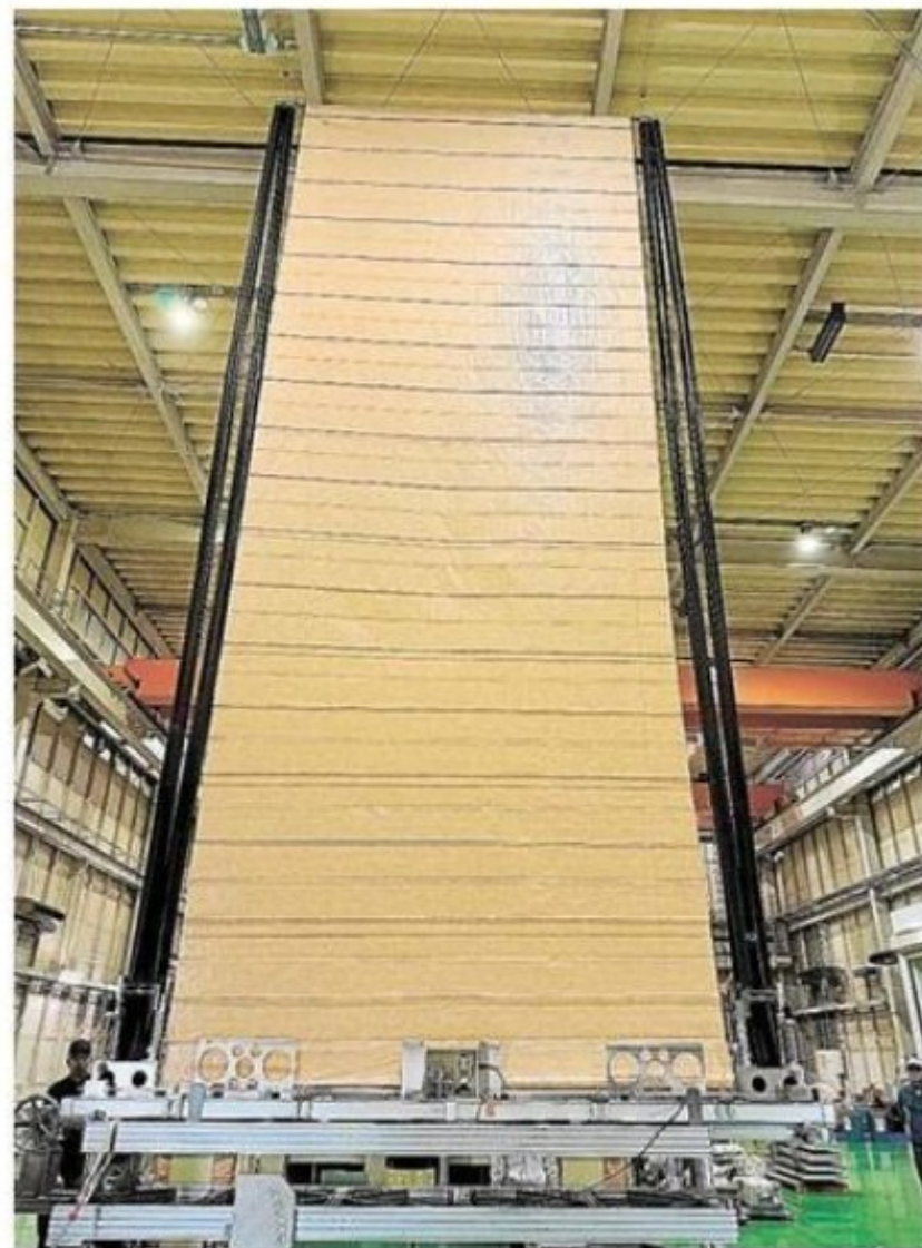
実物大模型で実施した展開試験 (提供:SAKASE/SLK)
