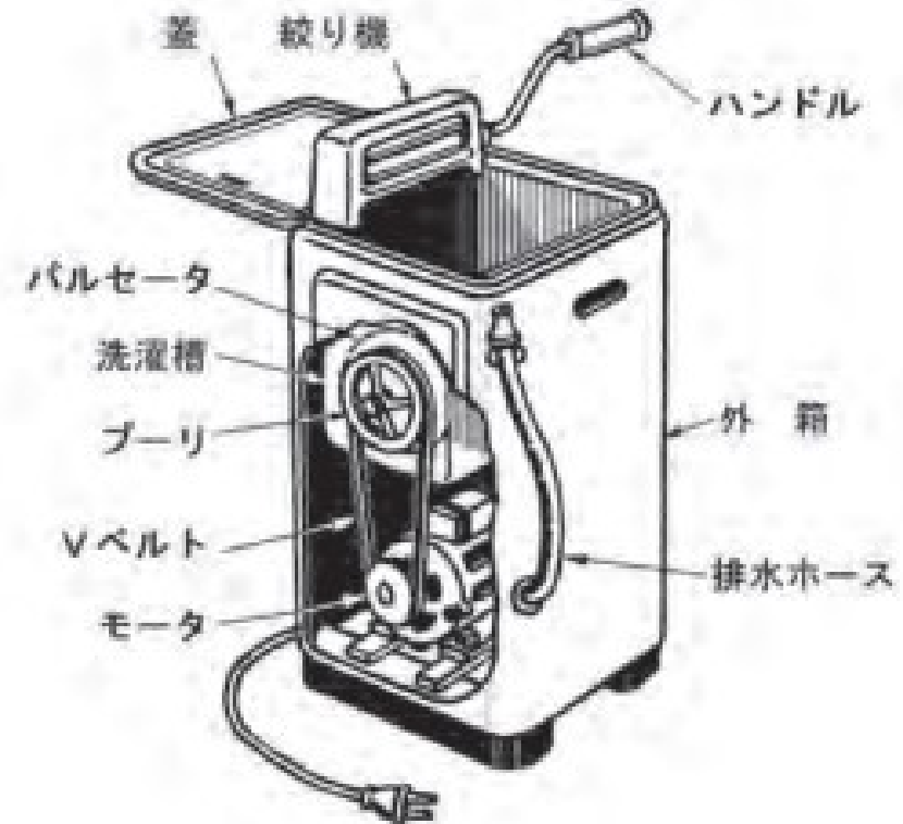
図 4.12 噴流式洗濯機の構造
