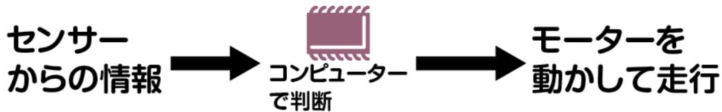
掃除ロボットは、目に見えない赤外線を、掃除機本体から発射して、壁などにぶつかってはね返ってきた光を捉えて距離を測る。この方法で、掃除を始める前に、壁と家具の位置、部屋の広さと形を調べ、**部屋の形や障害物の位置を示した地図を作成する。**
