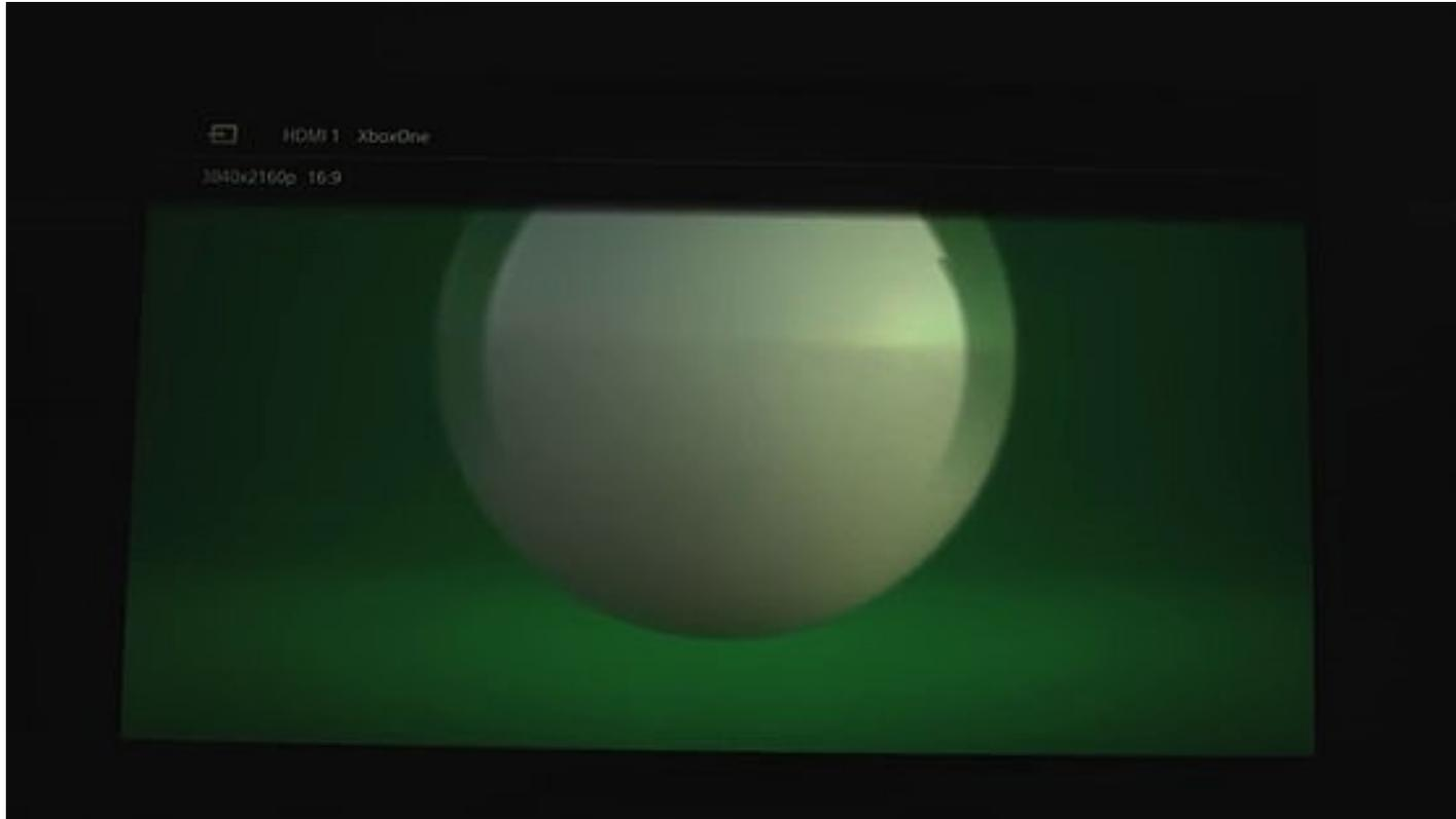
ゲーム機「Xbox 360」の起動画面をスーパースローで撮影した様子がコレ。画面にはブラウン管のような走査線は表示されず、画面全体が画像を映し出していることがわかる。その一方で、画面が描き変わる時には上から下に順番に切り替わっている様子も確認できる。これはつまり、液晶テレビは常に画面全体を表示する点がブラウン管テレビと大きく異なるのだが、画面の書き替えそのものは同じように上から下へと行われているというわけだ。
