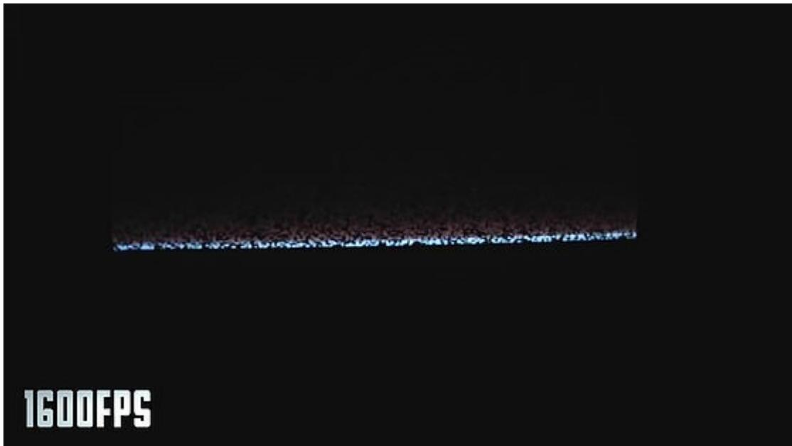
砂嵐を毎秒1600フレーム(1600fps)のシャッタースピードで撮影すると、このように細い砂嵐の帯が上から下へと流れていることがわかります。これは**走査線**と呼ばれる光の線で、ブラウン管テレビではこの走査線が画面を1秒間に30回上から下に流れて映像を映し出しています。
