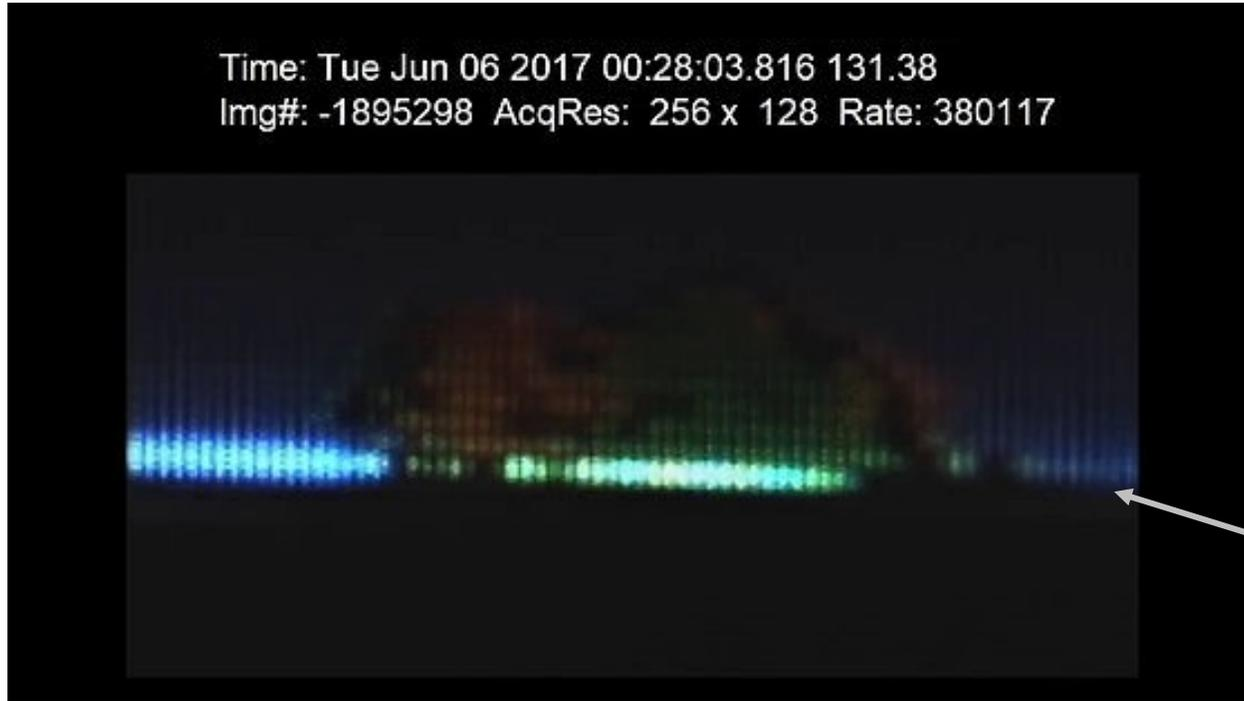
これは、高速度カメラで、毎秒38万フレームで撮影した画像。一本の線（走査線）の一部を示している。走査線が猛烈なスピードで画面を描画していることがわかる。
