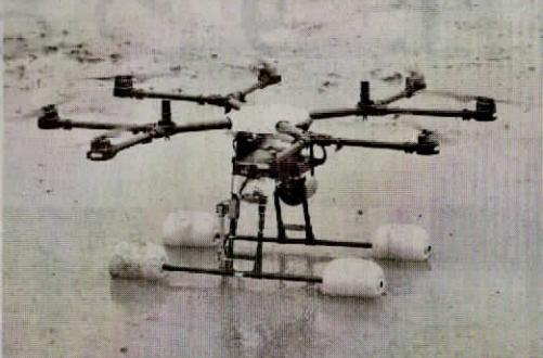
伊与衛門農園の水田でセンサーを差し土壤測定するドローン。離着陸を繰り返し複数箇所で測る（福井県あわら市、写真上）。レイットベースフクイが稲の種まきなどに導入したNTT系の機体。軽量でバッテリーのもちがよい（福井県坂井市）
