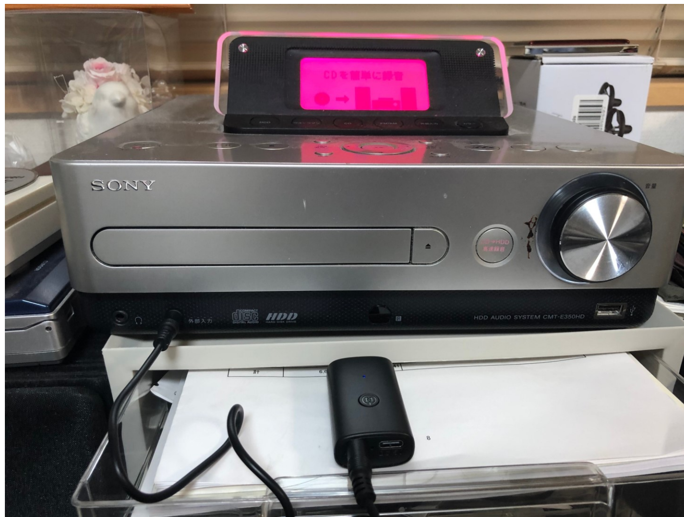
Bluetooth 受信機とオーディオ装置の外部入力端子をオーディオコードで接続する。これで、このオーディオは、無線で音楽をもらうことができる。
