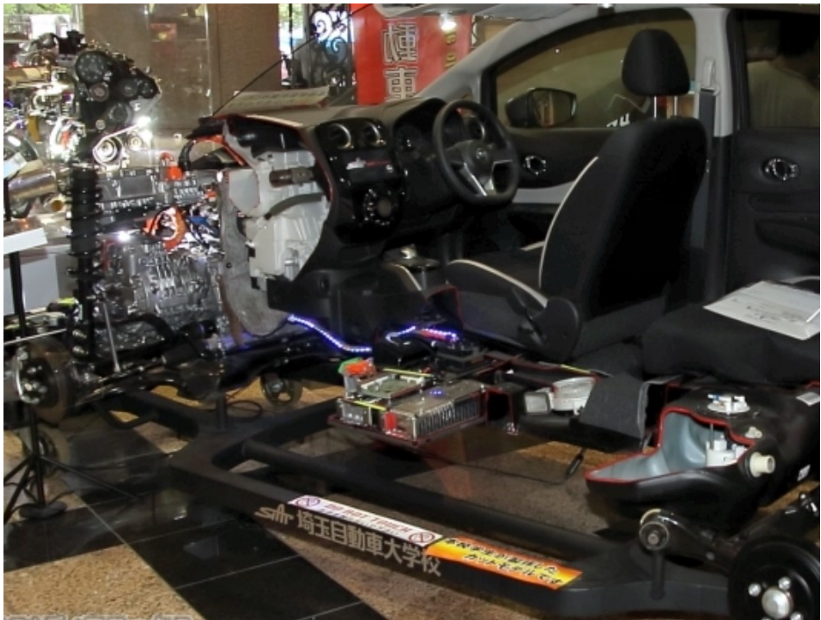
E-powerの電池は、前席の椅子の下にある。
