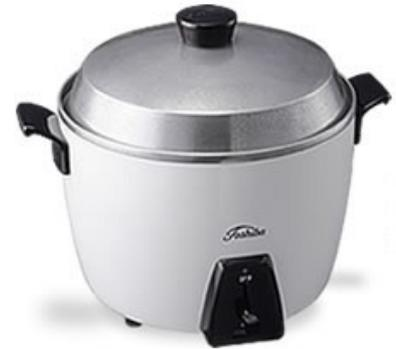
お米が入っている内釜に接触している熱板を加熱する方法で、お米を炊いている。この熱板にはヒーターが入っていて内釜を温めるが、釜底の中央には温度センサーがあって火加減のための信号を出している。
